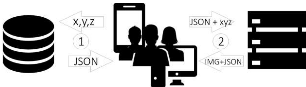
Figura 8. -Esquema de comunicaciones entre cliente y servidor. Elaboración propia en base a datos de REDIAM.
