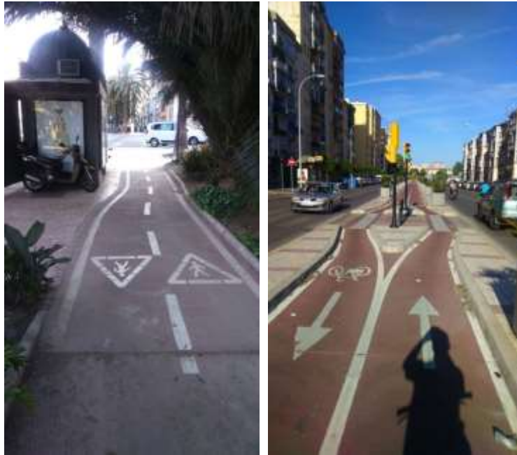
Figura 5. Ejemplos de carril bici con estrechamiento de la vía. Fuente: Elaboración propia.
